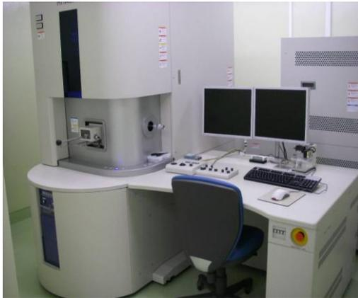
〔左上〕 原子プローブ電界イオン顕微鏡
