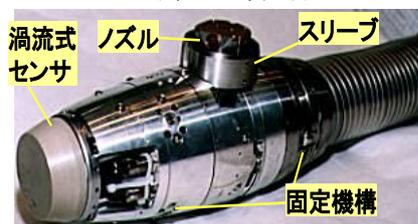
ノズルからのレーザー光により配管内壁を補修
