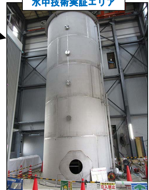
水中タンク (高さ約10.5m, 外径約4.5m)
