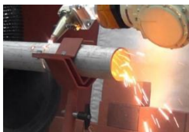
ふげん等での機器切断試験
