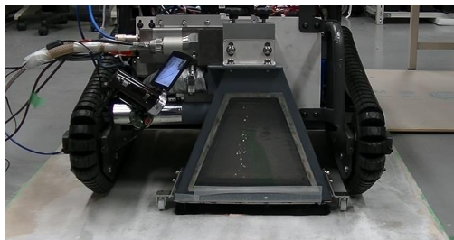
クローラ式小型レーザー除染装置を使った除染試験
