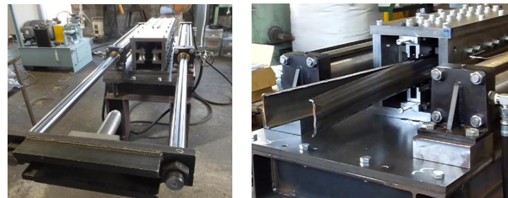
【除染作業を効率化する配管縦割り装置の開発】
