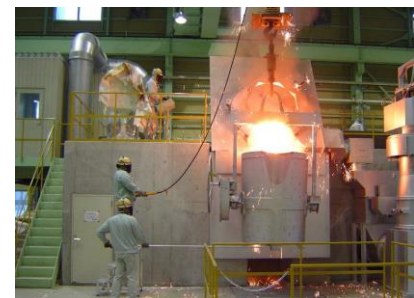
【クリアランスレベルの廃棄物(金属)再利用のための casting 設備(例)】
